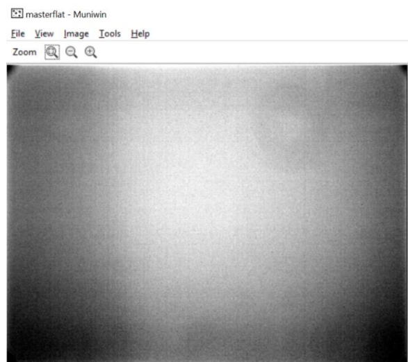
Abbildung A4b fertiges Master Flat Field
