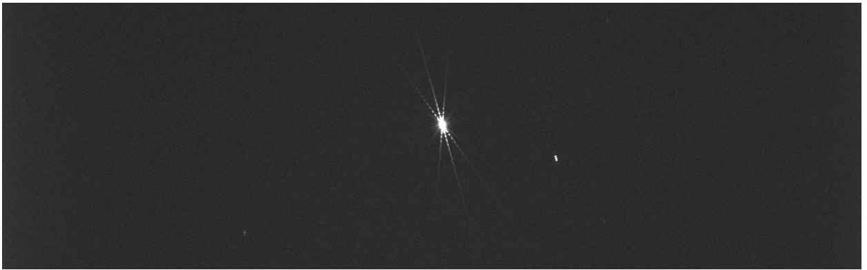
Abbildung 5 Blick durch die Bahtinov-Maske
